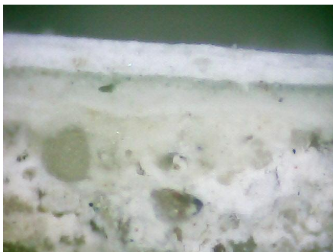
Stratygrafia warstw gurtu sklepienia korytarza.
