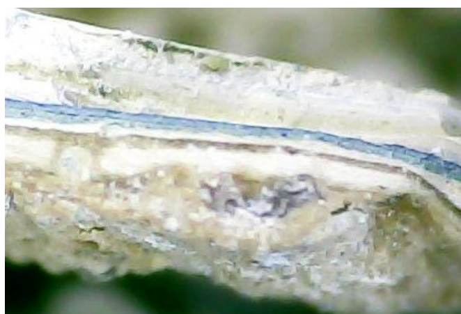
Stratygrafia warstw pilastra w holu.
